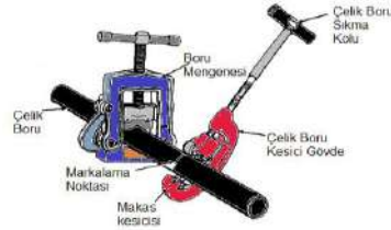
Görsel 4.6: Boru keski ile kesme yönü
