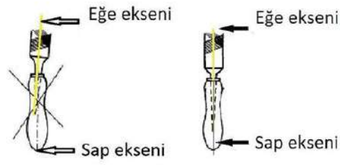
Görsel 3.6: Eğelere sap takma yöntemleri
