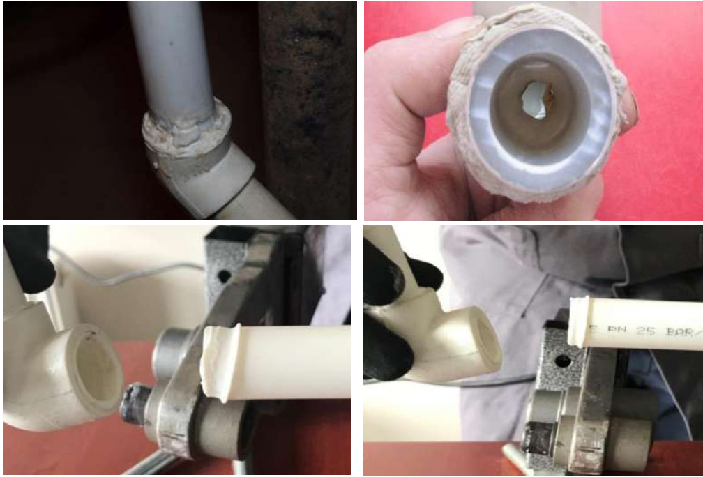
Grsel 5.9: PPRCboru kaynak iřleminde yapılan hatalar
