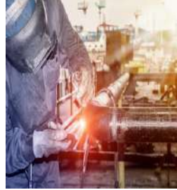
Görsel 13.18: TİG boru kaynağında çeşitli kaynak pozisyonları
