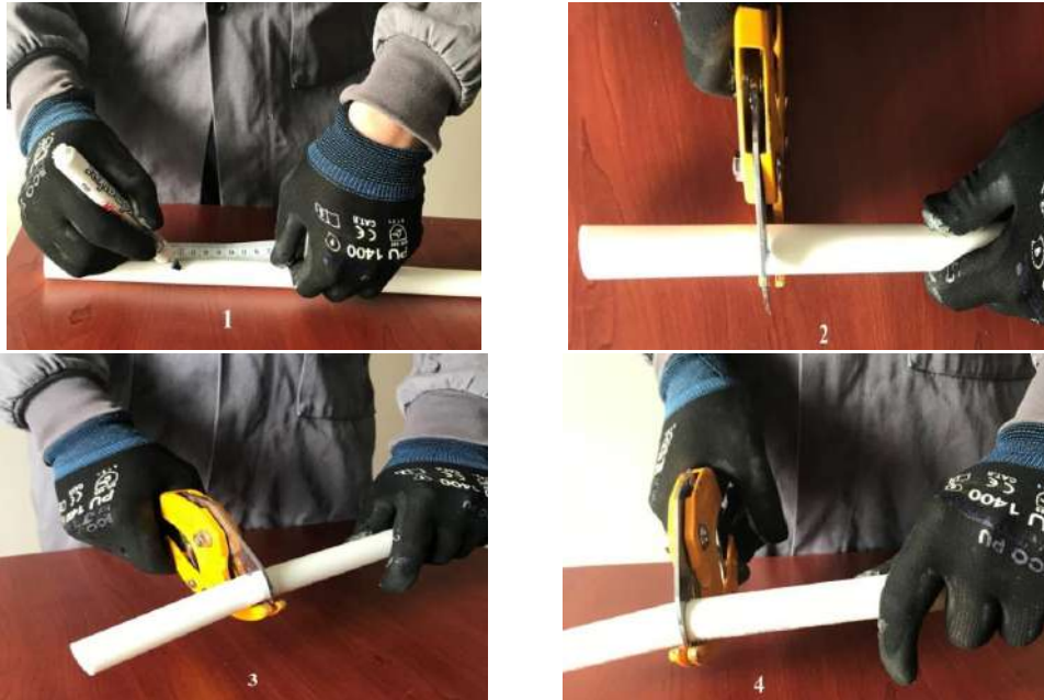
Görsel 5.4: Polipropilen boru kesme aşamaları
