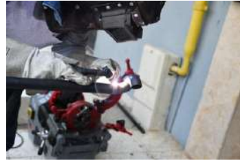
Görsel 13.18: TİG boru kaynağında çeşitli kaynak pozisyonları
