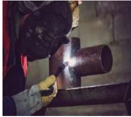
Görsel 13.19: TİG boru kaynağında ek telinin verilmesi
