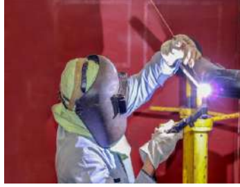
Görsel 13.18: TİG boru kaynağında çeşitli kaynak pozisyonları
