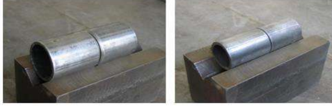
Görsel 12.26: Boruların puntalanmasında kullanılan -V- yatakları
