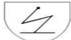
Statik Elektriğe karşı koruma
